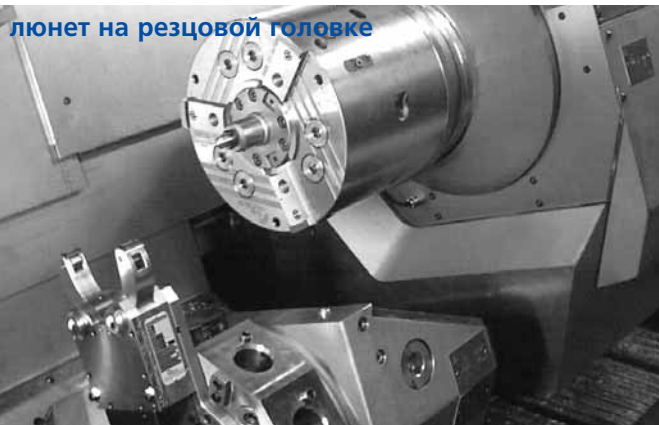
люнет для обработки валов в авиастроении
