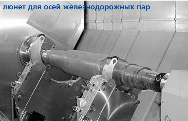
люнет на резцовой головке
